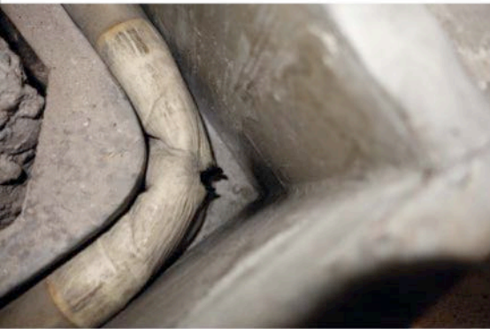
links und oben: Risse in den Lederabdichtungen der Bälge
