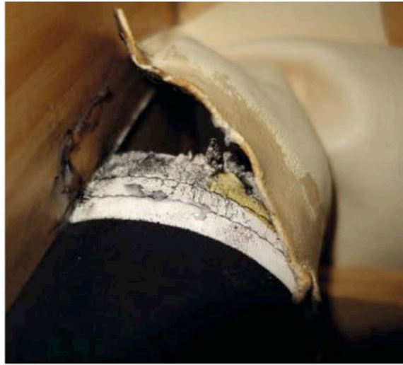
links und oben: Risse in den Lederabdichtungen der Bälge
