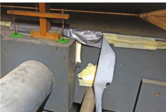
links: provisorisch abgeklebte Balgfalten
